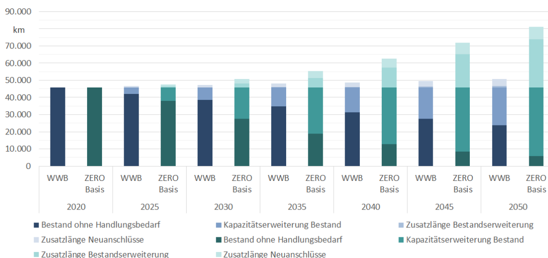
Bild A.2 Vergleich der Entwicklung der Leitungslängen der NE 5 der Szenarien WWB und ZERO Basis im zeitlichen Verlauf von 2020 bis 2050
